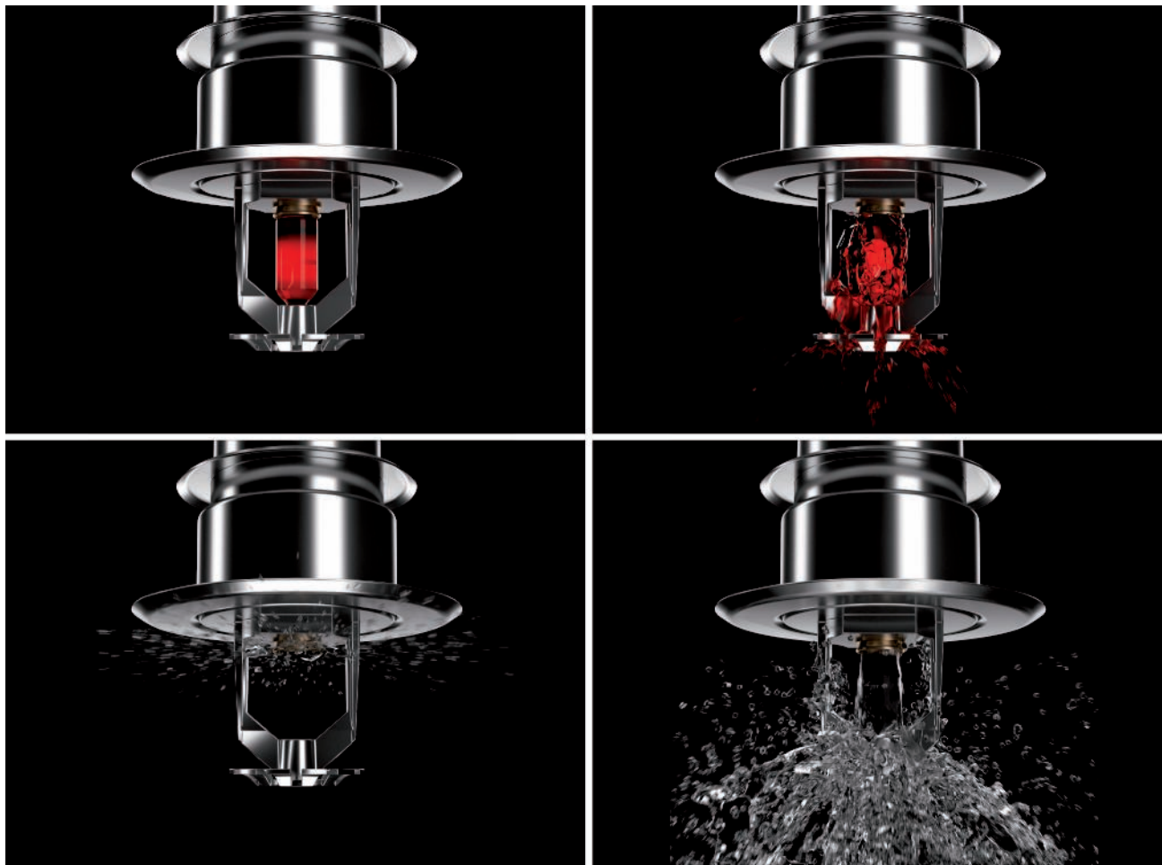
Activeren van een sprinklerkop bij overschrijding van de nominale temperatuur van 68 °C aan de glasampullen
