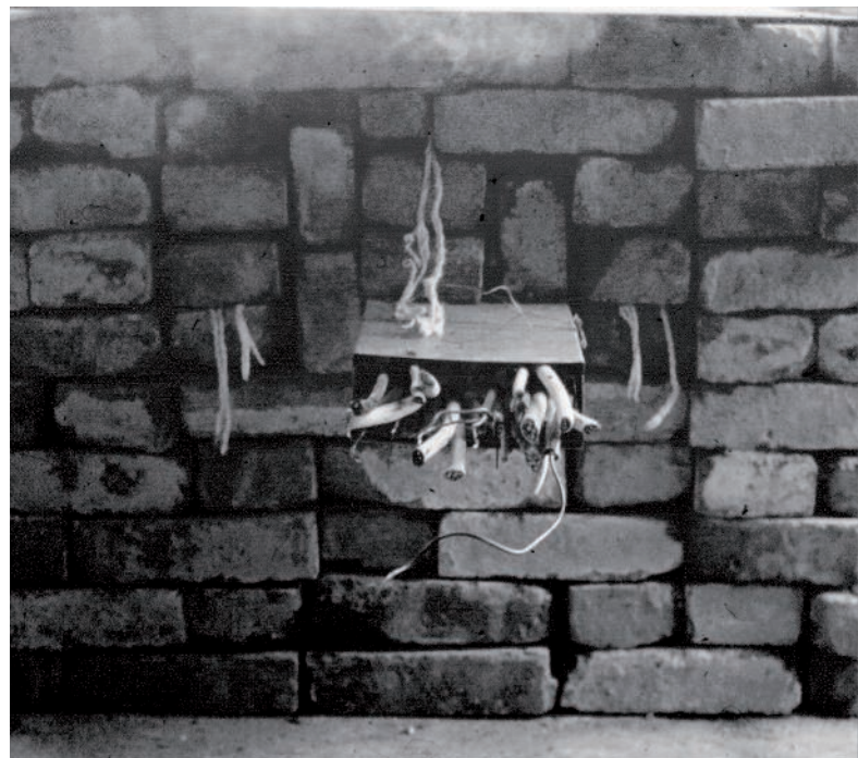
Testopstelling van de eerste brandwerende kabeldoorvoer van OBO
