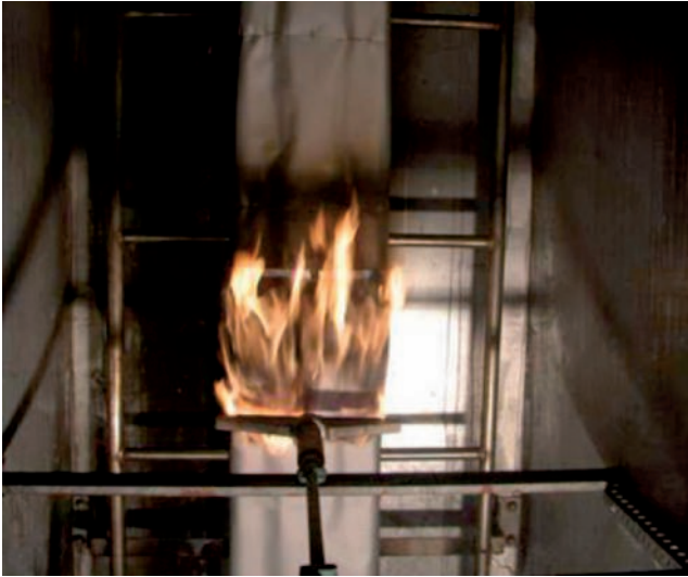
Beproeving van de kabelbandage
