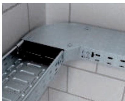
Montage deksel voor hulpstukken De hulpstukdeksel wordt met draaigrendels op de kabelgoot bevestigd, doordat de draaigrendel door 90° verdraaien onder de ingerolde zijkant van de kabelgoot wordt geklemd.
