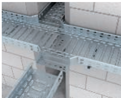
Montage aanbouw-T-stuk Magic Eenvoudige montage van de hulpstukken dankzij de steekkoppeling. Daarbij wordt de kabelgoot met het veerelement van bovenuit over de mof van het hulpstuk geklikt.
