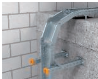
Montage scharnierbocht verticaal dalend Scharnierbocht verticaal dalend voor overbrugging van hoogteverschillen. De scharnierbocht wordt met scharnierverbinders met de kabelgoot verbonden.
