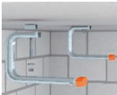
Plafondmontage TP-wand- en plafondbeugel Universele montage van de wand- en plafondbeugel TPD aan het plafond (met afstandsstuk DS 4). Maximale tracébreedte 300 mm.
