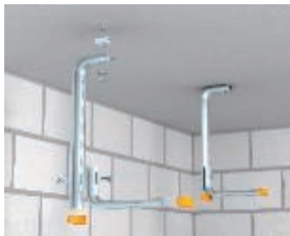
Montage TP-hangprofiel met enkelzijdige consolebevestiging Plafondmontage van een TP-hangprofiel met afstandsstuk DS 4 en enkelzijdige consolemontage. Maximale tracébreedte 300 mm.
