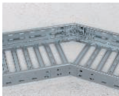
Richtingsverandering met afzonderlijke kabelgoten Ingekorte kabelgoten samenvoegen en van binnen op de aansluitingen met hoekverbinders type RWL.. vastzetten.
