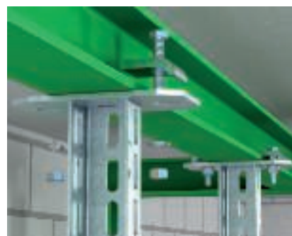
Directe klembevestiging aan een stalen drager Directe klembevestiging van een U-hangprofiel aan een stalen drager met behulp van klemhoek KWS. Tracéverloop in de lengterichting van de stalen drager.
