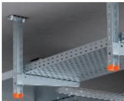
Toepassing plafondmontage Plafondmontage van een kabelgoot met hangprofiel en wand- en profielconsole.
