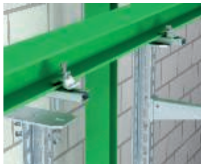
Klembevestiging met extra C-profiel Toepassing van een extra C-profielrail type MS bij bredere stalen dragers. Trajectverloop in de lengterichting van de stalen drager.
