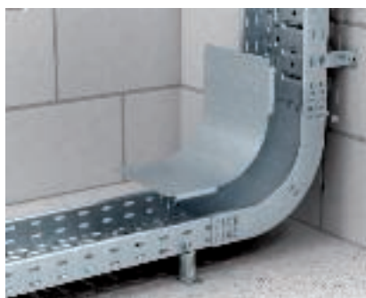
Bocht 90° (stijgend/dalend) De verticale 90°-bocht wordt over de zijkant van de kabelgoot geschoven en met bouten FRSB M6x12 mm vastgeschroefd. Het deksel wordt er los opgelegd en met het aankomende kabelgootdeksel bevestigd. Voor een extra bevestiging kan de dekselklem DKU worden gebruikt.
