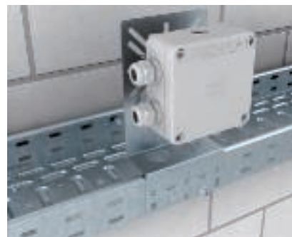
Montageplaat met snelkoppeling Bevestiging van de montageplaat type MP op de zijkant van de kabelgoot. De montageplaat kan met de snelbevestigingen op de zijkant worden vastgezet of met bouten type FR5B 6x12 mm permanent worden bevestigd.
