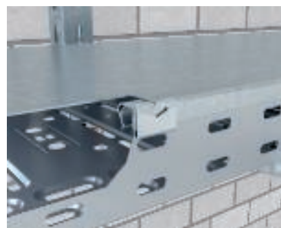
Schroefloze dekselmontage met dekselklem De deksels worden schroefloos gemonteerd met niet geperforeerde deksels en de dekselklemmen type DK DRLU. De dekselklemmen worden eenvoudig aan de zijkant van de kabelgoot vastgezet.
