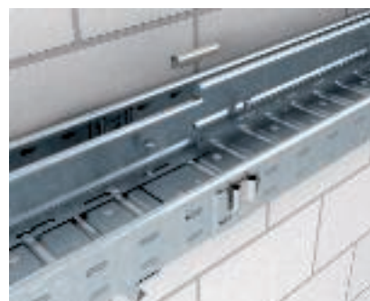
Geschroefde montage van een scheidingschot Geschroefde bevestiging van het scheidingschot TSG 60 met platkopbouten M6x12. Het scheidingschot kan over de voeg worden geplaatst en met de verbinders TSGV schroefloos worden verbonden.
