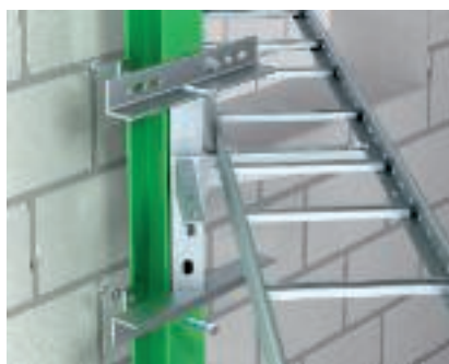
Adapterplaat 45°, geklemd aan stalen drager Montage van de adapterplaat 45° type KA-E 45 op stalen dragers met klemhaken of spanklemmen. Als extra ondersteuning bij moeilijke tracés in/aan hoeken.
