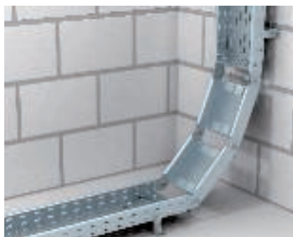
Montage scharnierbocht verticaal stijgend Scharnierbocht verticaal stijgend voor overbrugging van hoogteverschillen. De scharnierbocht wordt met scharnierverbinders op de kabelgoot gemonteerd.
