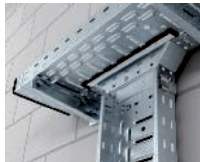
Montage aanbouw-T-stuk Magic verticaal (onderaanzicht) Verticale aanbouw van het aanbouw-T-stuk als aftaktrechter in de lengterichting. De opening in de kabelgoot wordt ter plaatse gemaakt. Voor breedten > 400 mm dient het verbindermateriaal afzonderlijk te worden besteld.
