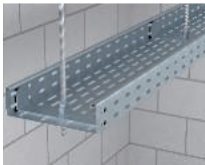
Toepassing centrale ophangbeugel Centrale ophanging van de kabelgootsystemen MKS, SKS, EKS, DKS en IKS met de centrale ophangbeugel type MAH en draadstang 2078/M10.
