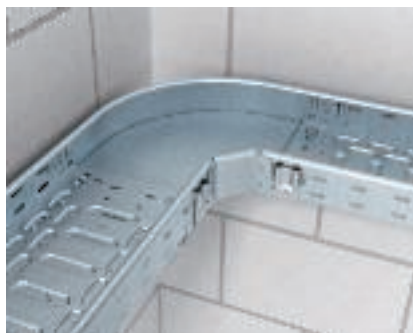
Montage Magic-bocht Eenvoudige montage van de hulpstukken dankzij de steekkoppeling. Daarbij wordt de kabelgoot met het veerelement van bovenuit over de mof van het hulpstuk geklikt.
