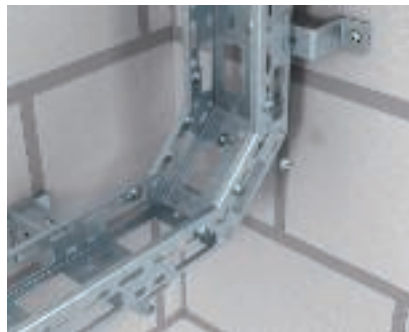
Verticale bocht 90°, stijgend Montage van een stijgende verticale bocht met scharnierverbinders type SV.
