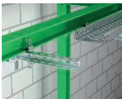
Kraagligger aan een stalen drager Met behulp van spanklauwen van het type TKS-L-25 kunnen U-profielen als kraagligger op stalen dragers worden gebruikt. Voor betrouwbare werking moeten afstandsstukken DSK worden gebruikt.
