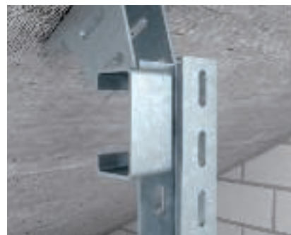
Montage afstandsstuk Montage van het afstandsstuk DSK 47 bij US 5-profielen resp. DSK 45 bij US 7-profielen in combinatie met variabele kopplaat KU 5 V resp. KU 7 VQP.
