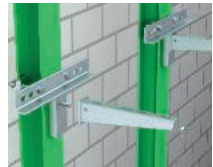
Klembevestiging aan verticale stalen drager Montage van de adapterplaat type KA-AW op verticale stalen dragers met klemhaken of spanklemmen. Op de adapterplaat worden wandconsoles type AW met de zeskantbout type SKS 12x40 GF bevestigd.
