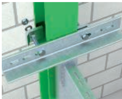
Klembevestiging verticaal Klembevestiging van een console in zware uitvoering met klemhaken of spanklemmen op een verticale stalen drager.
