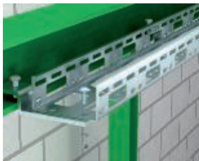
Klembevestiging, horizontaal Montage van een AZ-kanaal met bevestigingsklemstuk BFK in de lengterichting van de stalen drager. Maximale kabelgootbreedte 100 mm.
