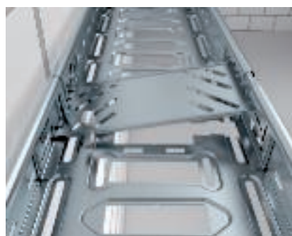
Montage snelverbinderset Magic KTSMV De voegplaat naar onder drukken tot deze vastgeklit zit. Ter versterking van de verbinding wordt vanaf de breedte 400 mm het vastschroeven van de voegplaat aangeraden.
