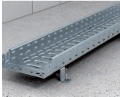
Vloerbevestiging met afstandsbeugel Montage van een kabelgoot op de vloer met behulp van afstandsbeugel DBL. Maximale kabelgootbreedte 600 mm.
