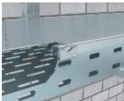
Schroefloze dekselmontage Ongeperforeerde deksels worden met dekselklemmen type DK DRLU gemonteerd. De dekselklemmen worden eerst aan de dekselrand geklemd en dan met deksel op de kabelgoot-zijkant geklikt.
