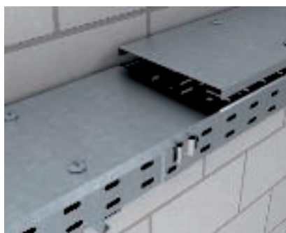
Dekselmontage met draaigrendel De deksel wordt met draaigrendels op de kabelgoot bevestigd, doordat de draaigrendel door 90° verdraaien onder de ingerolde zijkant van de kabelgoot wordt geklemd.
