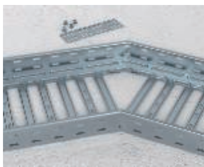
Richtingsverandering door insnijden van de kabelgoot Kabelgoot insnijden, buigen en de ingekorte stijl met een hoekverbinder type RWL.. vastzetten.
