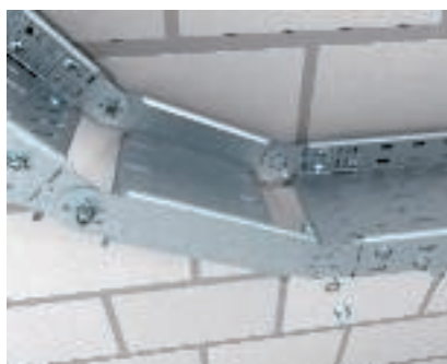
Montage scharnierbochtelement verticaal Montage van het scharnierbochtelement verticaal voor maken van scharnierbochten. Het scharnierbochtelement wordt met scharnierverbinders met de kabelgoot verbonden.
