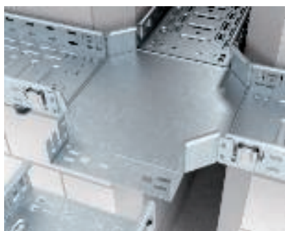
Montage kruisstuk Magic Eenvoudige montage van de hulpstukken dankzij de steekkoppeling. Daarbij wordt de kabelgoot met het veerelement van bovenuit over de mof van het hulpstuk geklikt.
