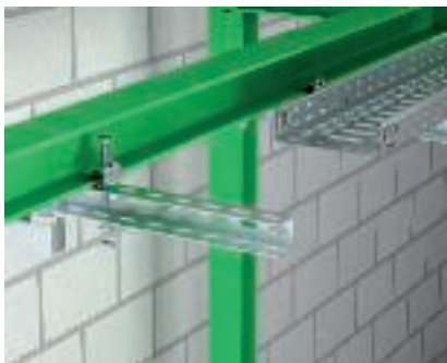
Kraagligger aan een stalen drager Montage van U-profiel als kraagligger op een stalen drager. Bevestiging afhankelijk van de belasting met klemhaken of spanklemmen. Bevestiging met afstandsstukken type DSK.
