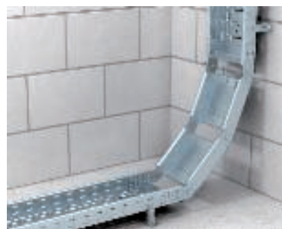
Montage scharnierbocht verticaal stijgend Scharnierbocht verticaal stijgend voor de overbrugging van hoogteverschillen of de overgang van horizontaal naar verticaal. De scharnierbocht wordt direct met scharnierverbinders aan de kabelgoot verbonden.
