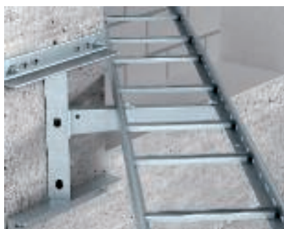
Adapterplaat 45°, betonmontage Montage van de adapterplaat 45° type KA-E 45 op een betonnen wand. Voor extra ondersteuning en bij de uitvoering van moeilijke routes op profielen en ruimtehoeken.
