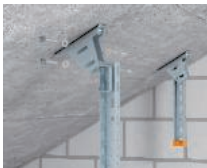
Montage van een verstelbare kopplaat Bevestiging van de variabele kopplaat KU 5 V aan schuine betonnen plafond met keilbouten en afstandsstuk DSK 47.
