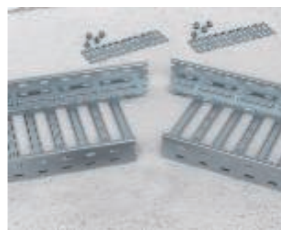
Richtingsverandering met afzonderlijke kabelgoten Om een richtingsverandering met 2 afzonderlijke kabelgoten te maken, worden 2 hoekverbinders gebruikt voor het fixeren.
