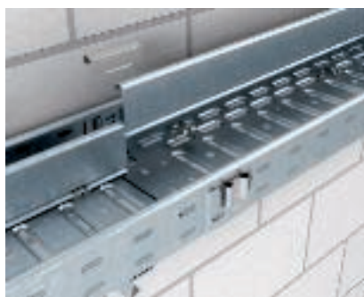
Schroefloze montage van het scheidingschot Schroefloze montage van het scheidingschot TSG ... met het klemstuk KS KR. Het scheidingschot kan zonder bewerking over de voeg worden geplaatst en met de verbinders TSGV schroefloos worden verbonden.
