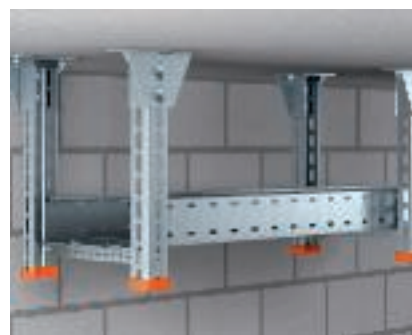
Montagevoorbeeld Dubbelzijdige ophangprofielmontage van U-profielen met dwarsbalk. Bevestiging van een verspankabelgoot type WKSG 110 met platkopbouten op het dwarsprofiel.
