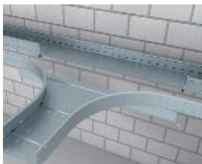
Montage aanbouw-T-stuk Aanbouw-T-stuk in combinatie met verspankabelgoot. De zijkant wordt voor de montage weggehaald.
